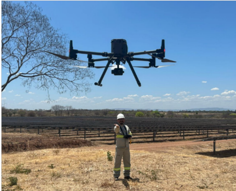
Imagem 04 - Drone com câmera termográfica sob usina fotovoltaica
